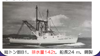
総トン数81、排水量142t、船長24 m、鋼製
