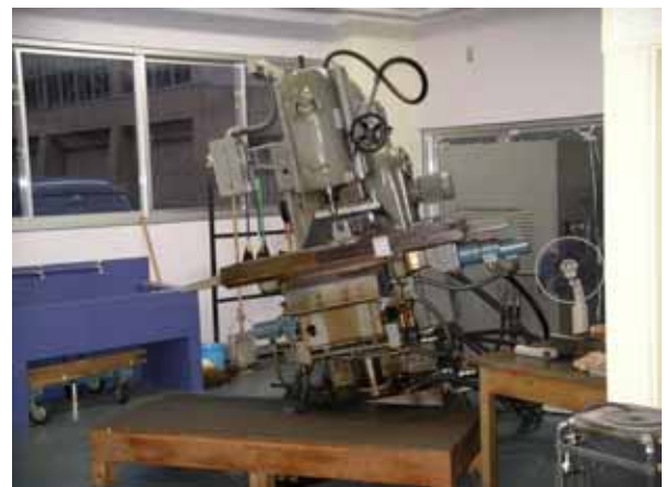
実習機械設備の傾斜
