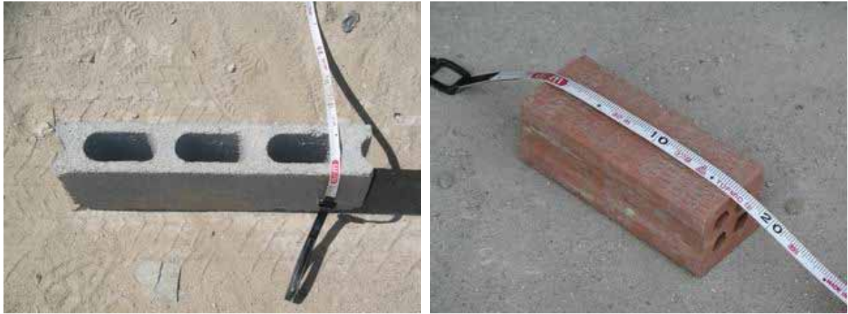
写真 5.1-4 : 一般的なブロック (180x390x65) と有孔レンガ (65x65x170)
