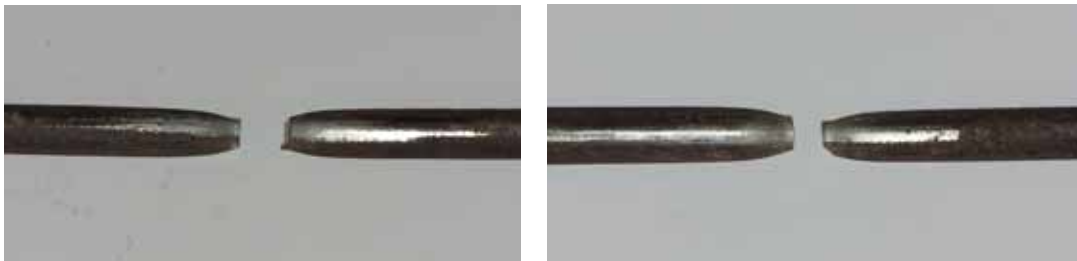
付図 1.3 : タイ・新築現場の鉄筋 の応力度 - 歪度関係 (写真 左 : - 1 / 右 : - 2 )
