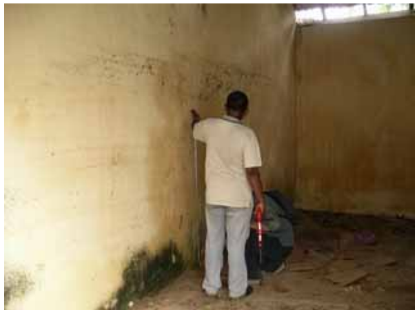
写真 4.19-3 : 調査した小屋 とその近くの建物での津波高さ実測 (GL+2.05m)
