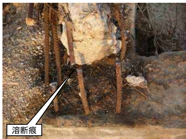
写真 5.9-4 : 倒壊した柱の破壊面 (左: 破断痕 / 右: 溶断痕)
