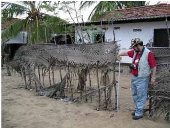
写真3：津波高さの計測（ 0.9\text{m} 程度）
