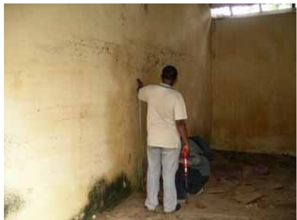
写真 3 : 調査した小屋 とその近くの建物での津波高さ実測 (2.05m)
