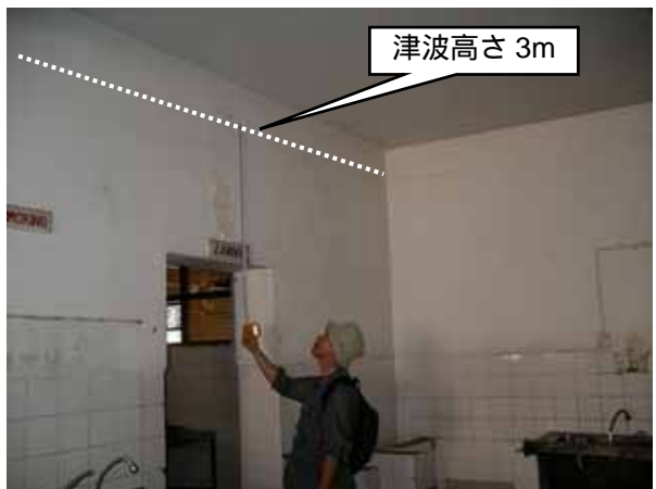
写真 4：砂丘を越流した津波による被害（基礎の洗掘と厨房での津波高さ計測）
