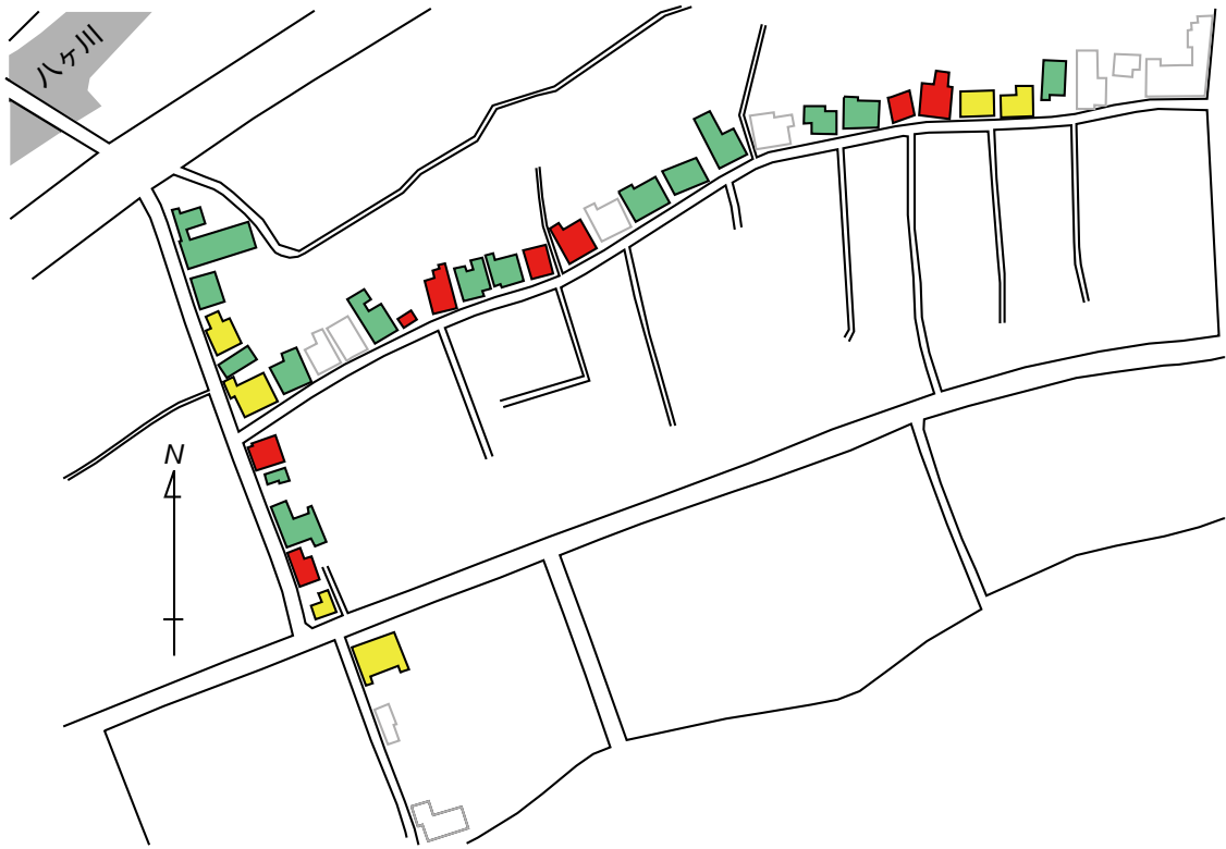
図6 1階鉛直部材の目立った傾斜角 (緑: 1/60以下, 黄: 1/60~1/20, 赤: 1/20超)
