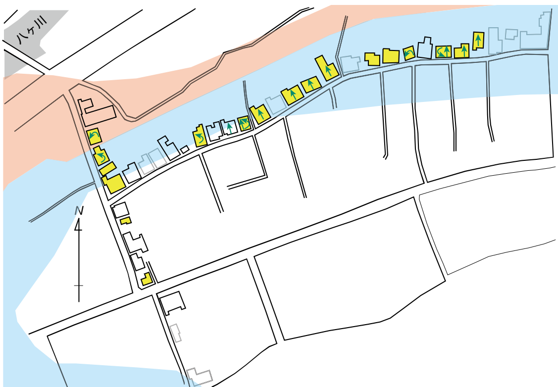
図 5 基礎の被害状況（黄：基礎にひび割れ・欠け有，直線矢印：基礎の水平移動，曲線矢印：基礎の転倒・不同沈下）
