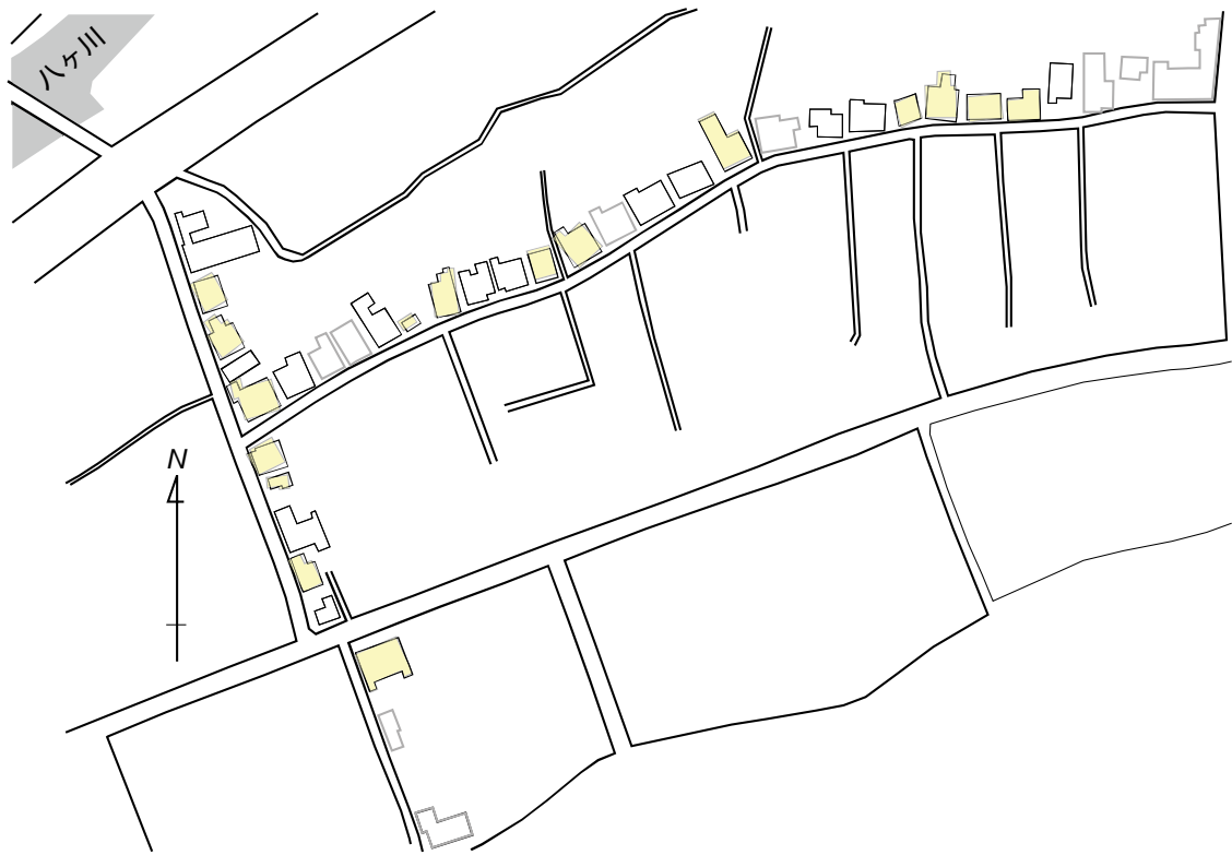
図8 上部構造と基礎とのズレ (黄：ズレの見られた建物)
