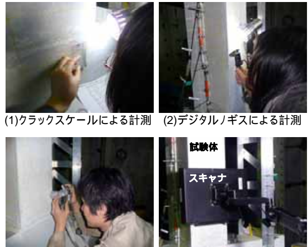
写真 - 1 各計測方法によるひび割れ計測の様子
