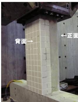
写真1 タイル貼付後の試験体
