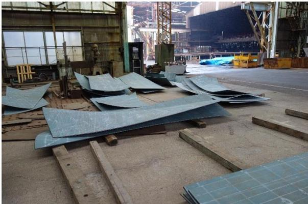
図 3.18 熱間加工により再現された鋼板の曲面
