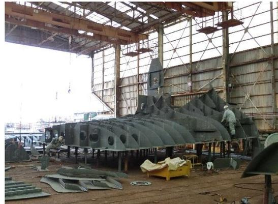
図 3.19 船底の骨組み（上下が反転した状態）
