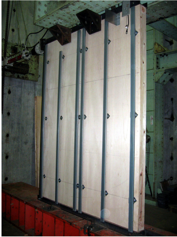
写真 3-11 胴縁取付け例 (ezWgrip+縦胴縁)
