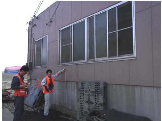
写真 3-22-1-2 浸水深の計測
