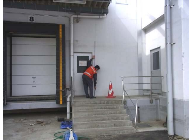
写真 3-25-4-2 浸水深の計測
