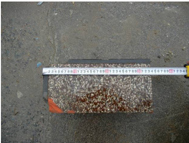
写真 3-16-3-3 レンガ・ブロック寸法計測
