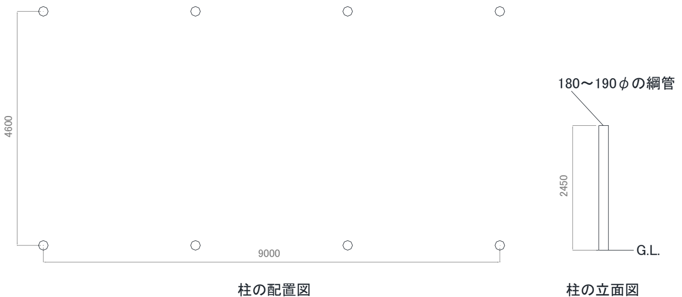
図 3-7-5-2 東屋（長方形）の柱の配置図・立面図（単位：mm）
