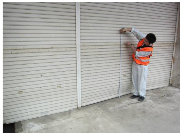
写真 3-24-1-2 浸水深の計測
