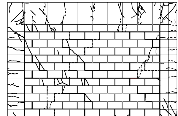
(b) 柔梁型試験体（+2.0%，第1サイクル）
